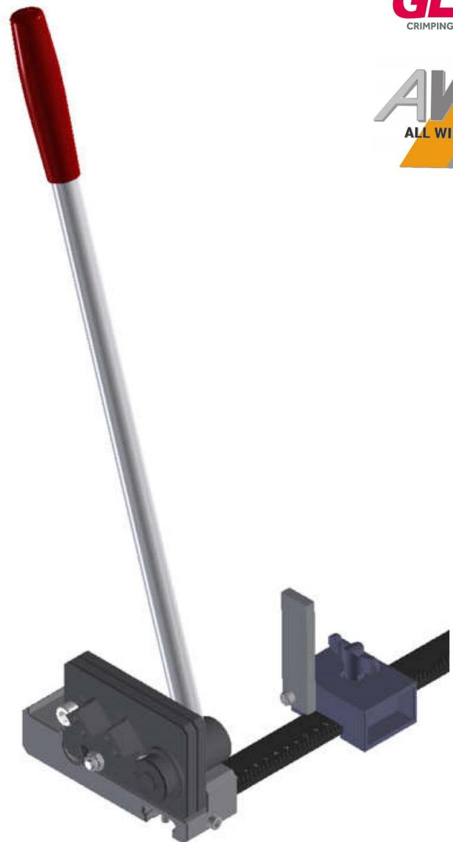
Der RC 200 dient zum Ablängen von Tragschienen (Hutschienen) der Größen TH 35 - 15 und TH 35 - 7,5. Mit geringem Kraftaufwand schneidet der RC 200 schnell und gratfrei die gewünschten Längen. Die Schnittkanten sind winkelgenau und benötigen keine Nachbearbeitung. Der Arbeitsplatz bleibt sauber und spänefrei. Die Maßschiene ermöglicht millimetergenaues Ablängen.
